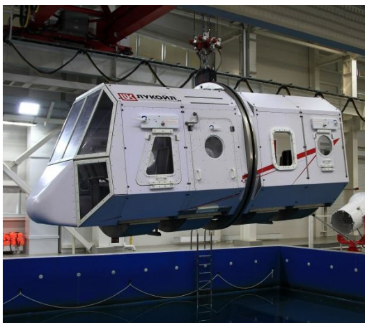
Рисунок 1 – Внешний вид погружного макета вертолета
